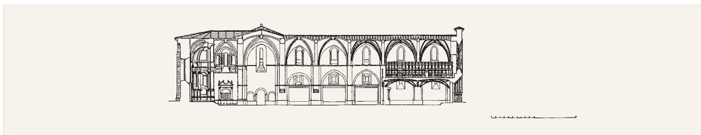
Sección longitudinal de la iglesia
