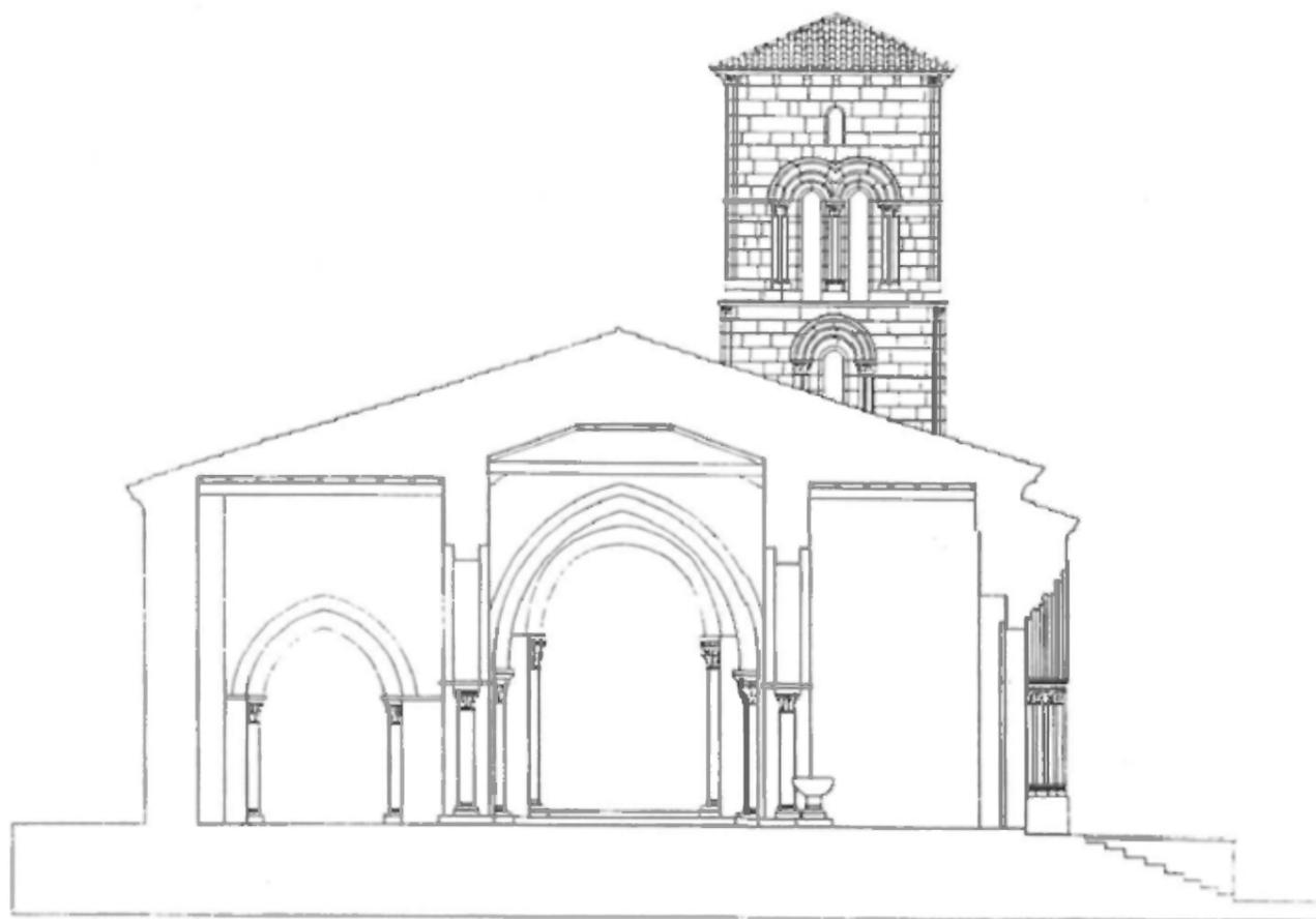
FIGURA 51.—Sección transversal de la iglesia donde se aprecia cómo la elevación del tejado inutiliza uno de los ventanales de la torre.
